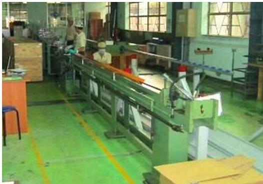
引抜、アニールの条件により外径寸法や振れ等の精度をコントロールします。
