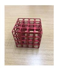
丸棒からの薄物NC旋盤加工一例
