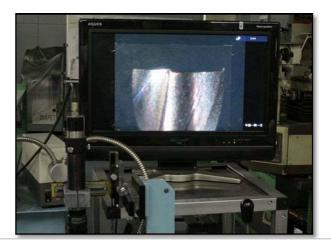
CCDカメラで拡大をしてモニターを見ながら作業をします
