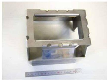
ステンレスの片研2.0tをレーザー加工し、曲げて溶接したものです。仕上げのバフもキレイです。
