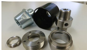
1工程で完成した部品群(左:油圧機器関連部品、右:工作機械関連部品)
