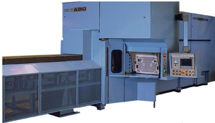
DISA231X 世界最高峰の無枠高速造型機
