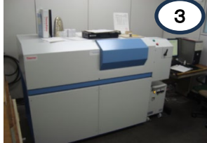
品質保証 材料試験装置 ①画像解析 ②万能試験機 ③発光分光分析機
