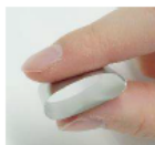
薄さ0.04mmのステンレス材チューブ
