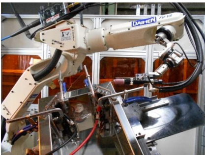
溶接ロボット(Tig溶接)
