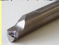
内部形状を最適化した防振ツール
