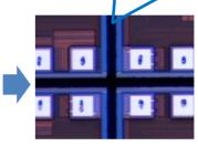
製品をダイヤモンドブレードによって個片状態に切り分けます。溝入れ加工も可能です。
