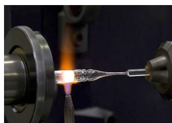
ガラスと金属の接合技術 (ハウスキーパーシール)
