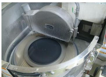
測定物: \phi 500\text{SiC} 平面研削加工 12\mu\text{m} 凹面仕上げ
