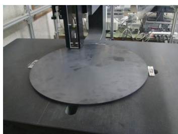
測定物: \phi 500\text{SiC} 平面研削加工 12\mu\text{m} 凹面仕上げ
