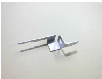
変形しやすい製品をバレル工法で処理
