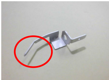
製品形状・要求膜厚 に応じた専用治具
