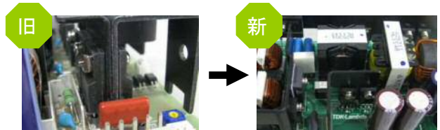
ネジ締めロボット(自動化)を考慮した配置に
