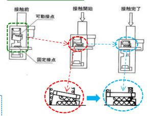
可動接片(A接点は上側接点、B接点は下側接点)が 固定接片へ接触する時に、斜めになでるような動きを することを「ローリング」または「ワイピング」と言います
