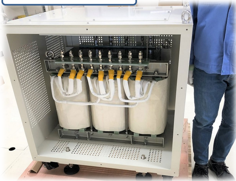
96kVA筐体入り電源トランス
