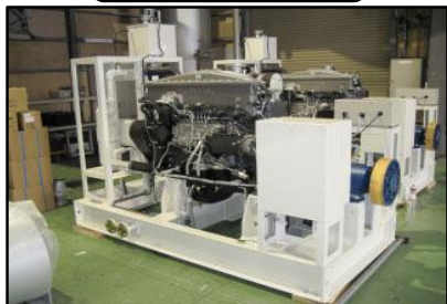
発電機動力装置
