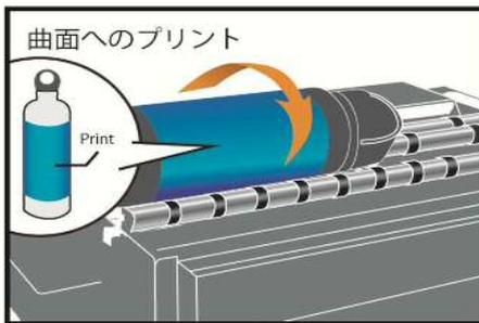
3042HG、UJF-6042にKEBABユニットを装着し、ローラーの上に素材をセット。専用ソフトでプリント開始。後は自動で360度プリントが始まります。長さ330mm & 直径10mm~110mmまでの素材に対応。
