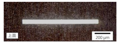
りん青銅, 厚さ50µm 電極: りん青銅 50µm x 1mm 加工時間: 1分25秒
