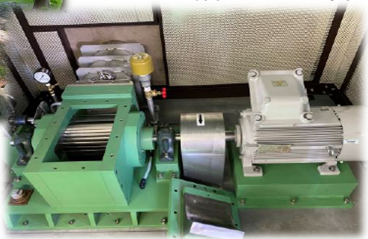
内部のクロスフロー水車
