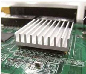
ヒートシンクや放熱板を接着・固定することで発熱部品の温度を下げます。
