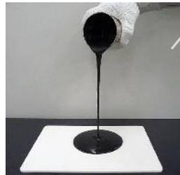
優れた流動性と密着性を併せ持つ高熱伝導・電気絶縁性の液状封止材料。
