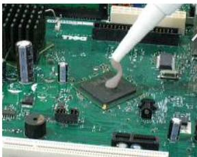
複雑形状の熱伝達断面・発熱部品の固定・接着に最適です。
