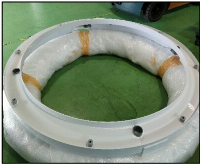
【樹脂 曲げ→接着組立 直径約2000ミリ】
